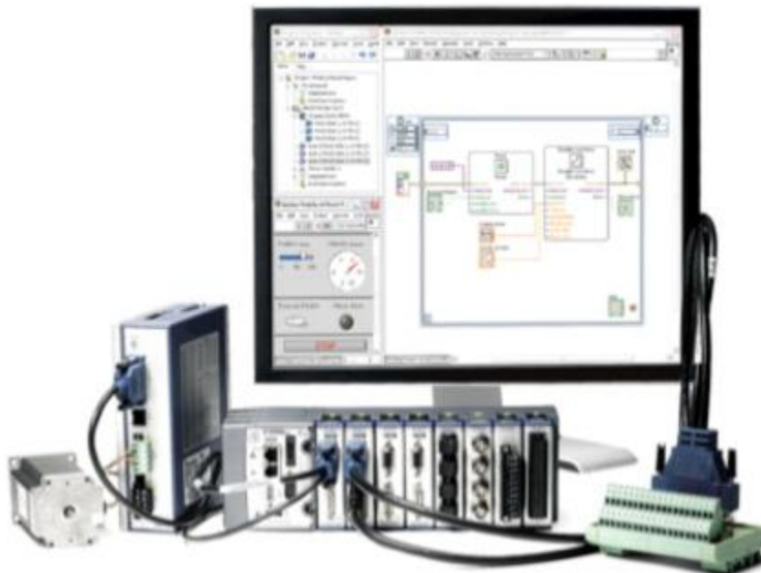
图5.31. 选择若干选项以简化NI 951x模块与驱动的直接连接
