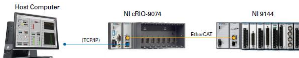
图5.9. 配置确定性以太网系统，连接cRIO-9074端口1至主机，连接端口2至NI 9144
