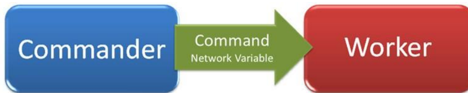
图 4.13 使用网络变量的简单命令构架
