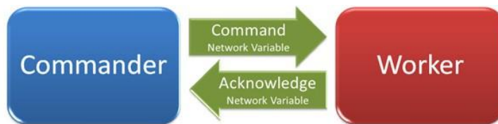
图 4.32 使用网络变量的简单的公认命令结构
