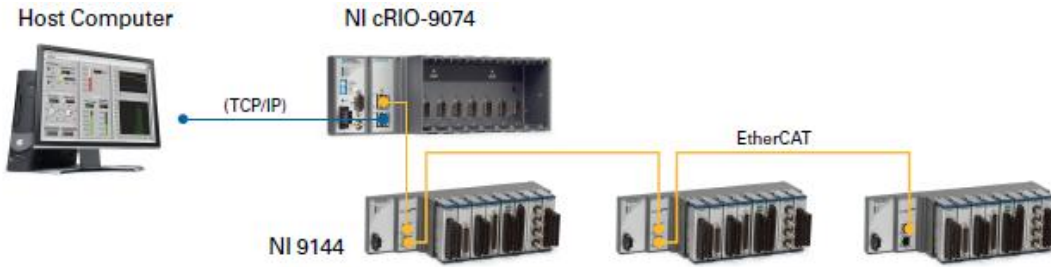
图5.7. Compact RIO硬件采用NI 9144确定性以太网机箱扩展时间先决系统
