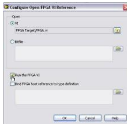
图6.12使用对话框配置Open FPGA VI Reference,可以选择VI或者位文件并进行配置使其调用时即执行
